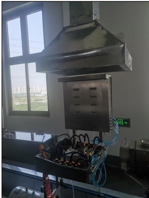
图 3-3 挤出工序 3#集气罩
