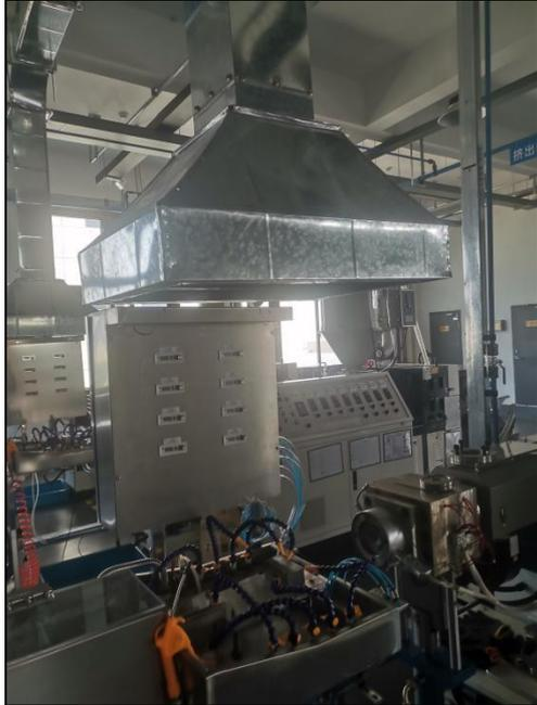
图 3-1 挤出工序 1#集气罩
